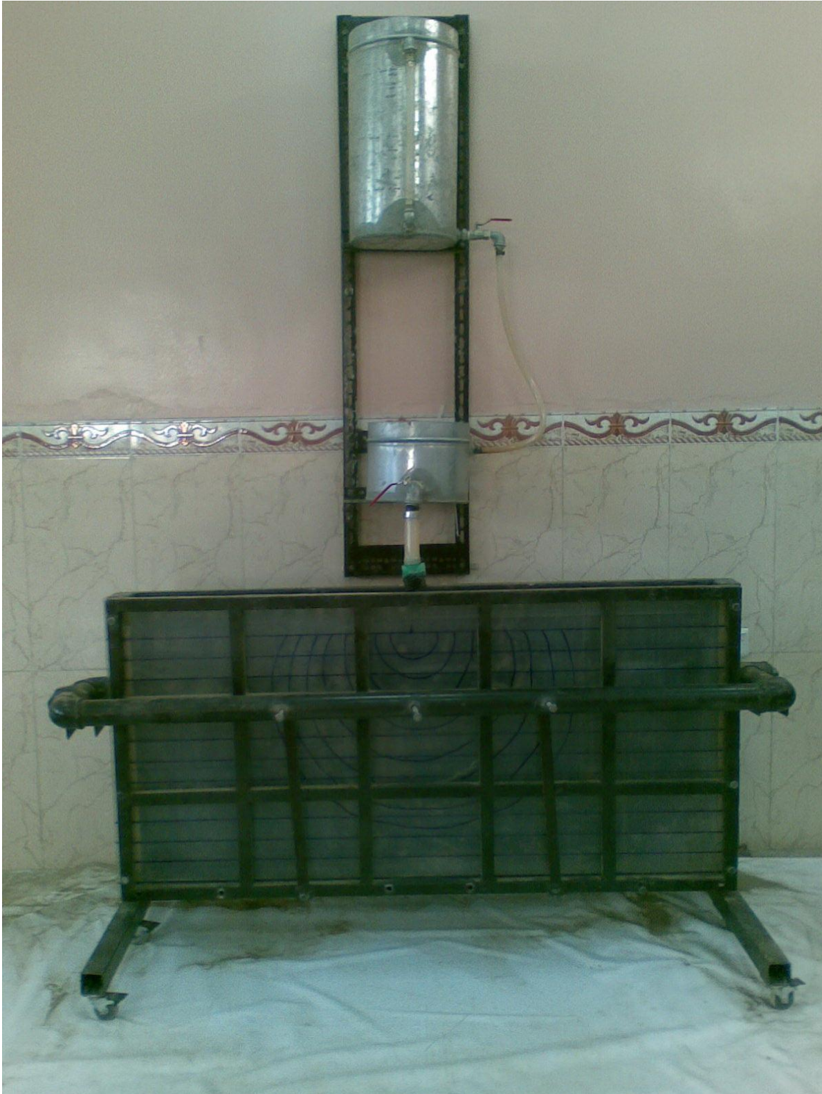
الشكل (1): حاوية التربة ومنظومة تجهيز الماء.
